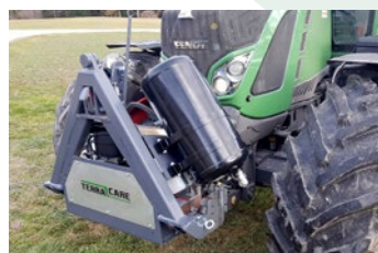
Gerätedreieck mit Schraubenkompressor
